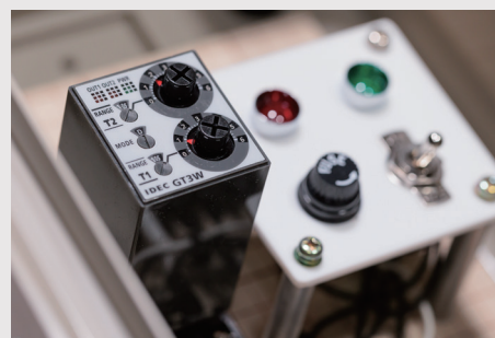
動作時間の調節を 簡単に行えるつまみ
